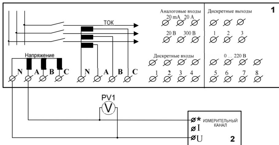
Рисунок 9 – Схема проверки диапазона и основной приведённой погрешности измерения напряжения переменного тока ( $U \leq 200$  В)
