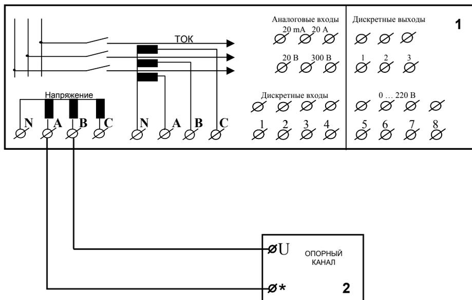
Рисунок 13 – Схема проверки диапазона и основной абсолютной погрешности измерения частоты напряжения переменного тока (по опорному каналу напряжения), при  $F < 70 \text{ Гц}$
