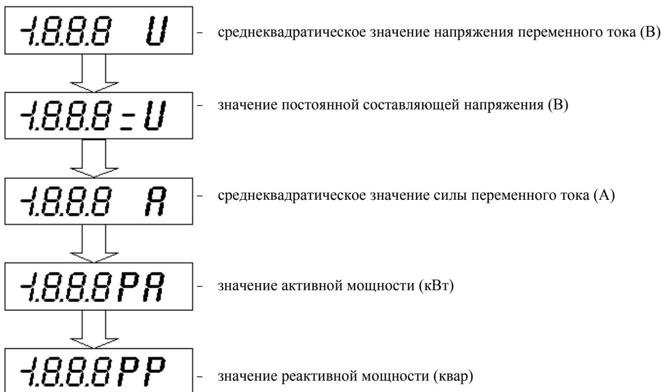
Пример измерений в режиме вольтметра:
