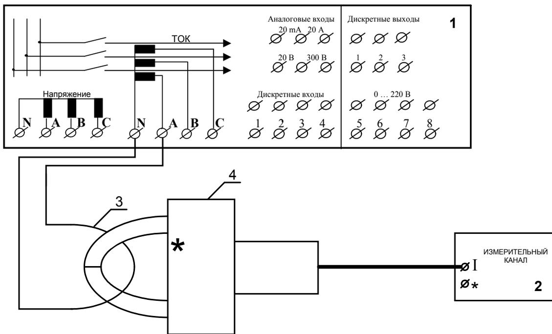
Рисунок 12 – Схема проверки диапазона и основной приведённой погрешности измерения переменного тока ( $I > 2 \text{ A}$ )
