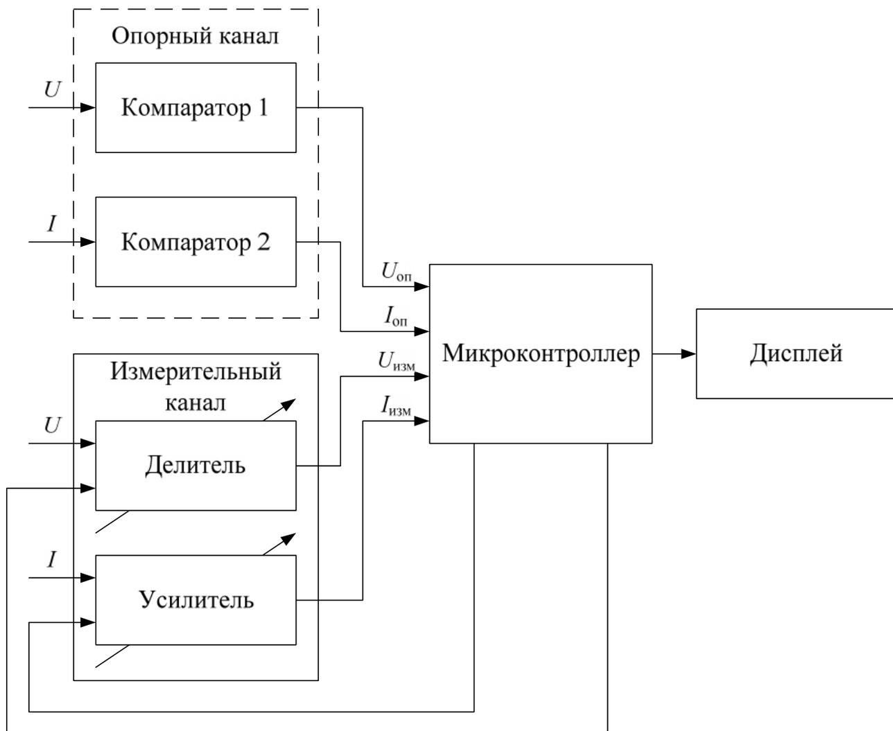
Рисунок 3 – Структурная схема прибора
