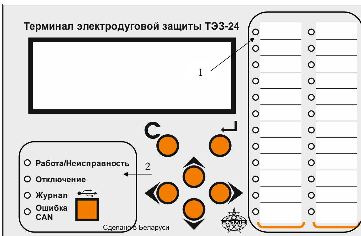
1 – индикаторы состояний МДО-1; 2 – индикаторы работы ТЭЗ-24
