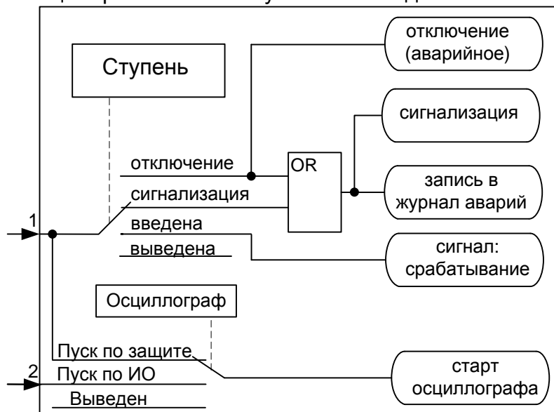
Рисунок 6.5 – Логическая схема направленной защиты от повышения тока (блоки)
