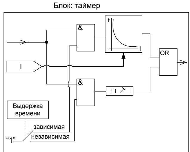
Блок-схема логики срабатывания 1 (общая для всех защит MP700 кроме токовых нулевой последовательности)
