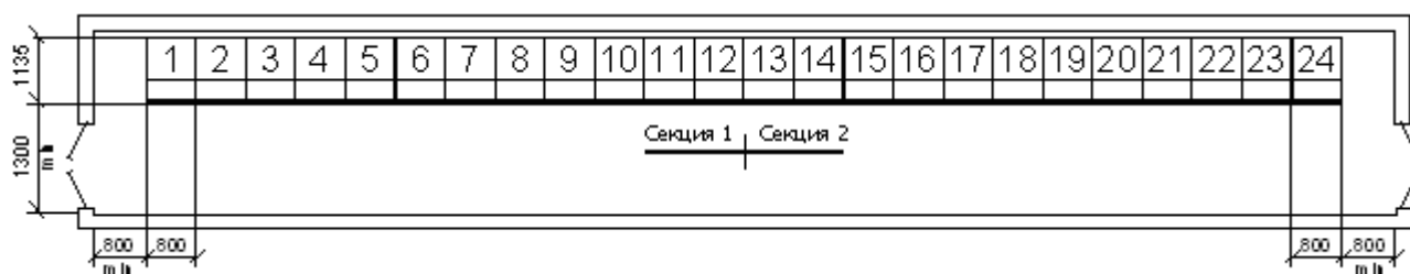
Рисунок Д.1 – Вариант однорядного расположения КСО-БЭМН (кабельный ввод, шкафа КРУ секционного выключателя (СВ) и секционного разъединителя (СР) расположены рядом)
