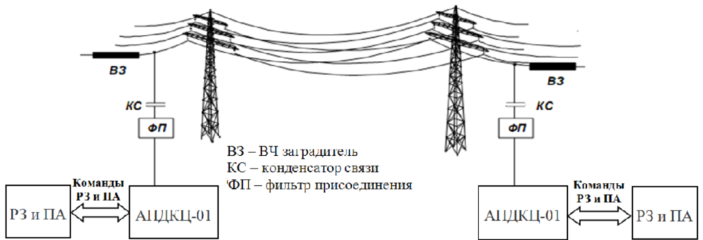
Рисунок 1.1 – Организация каналов передачи сигналов команд РЗ и ПА с применением СТРЕЛА
